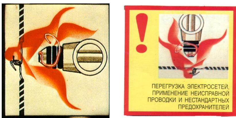
*Неисправный предохранитель с «жучком»*
